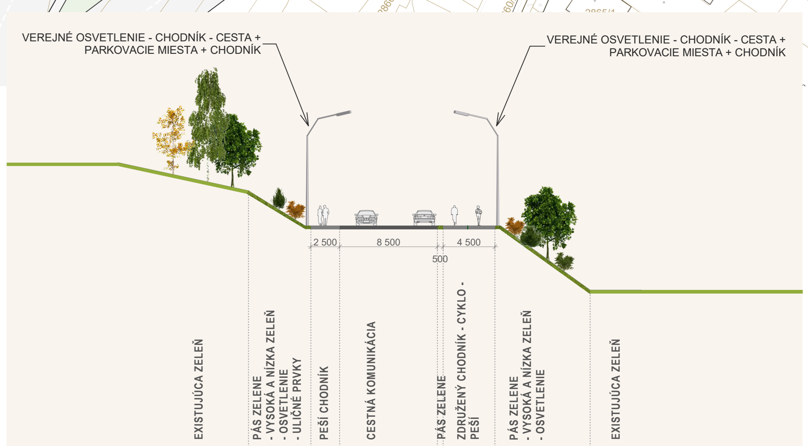
PRIEREZ ULICOU PRED KRUIOVÝM OBJAZDOM KPT. NÁLEPKU - STARÝ BLICH - NAPOJENIE NA OBCHVAT - M 1:200
