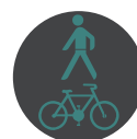
S 5d Kombinovaný signál pre chodcov a cyklistov so zeleným svetlom so znamením „Voľno“
